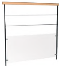
Verre stadip 44.2 / Tubes 10 mm Soubassements en verre stadip 44.2 sur pinces et lisses horizontales en inox ø10 mm
