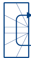
TVT 2/4 tournant composé d'une volée centrale et de deux quartiers
