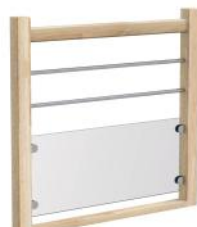
Verre stadip 44.2 / Tubes 16-20 mm Soubassements en verre stadip 44.2 et lisses horizontales en inox ø16 mm ou acier thermolaqué ø20 mm teinte RAL au choix
