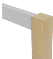
P3 Tête de poteau chanfreinée arasée à la main courante
